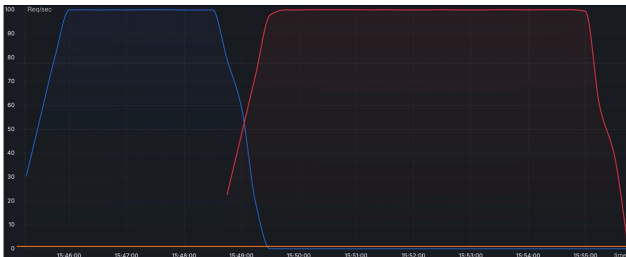
Рисунок 4.2 Кероване перемикання трафіку під час зміни версії сервісу в Kubernetes
